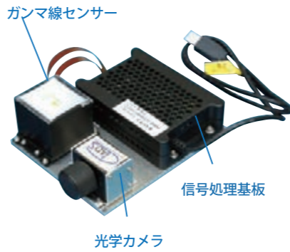
図1 開発した680gの小型軽量コンプトンカメラ (写真は遮蔽体を取り外している)
